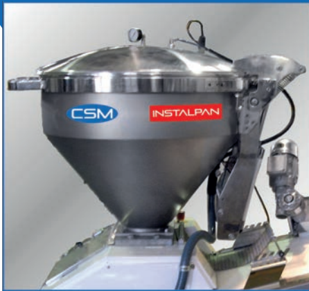
Tolva presión 120 kg. Pressure hopper 120 kg.
